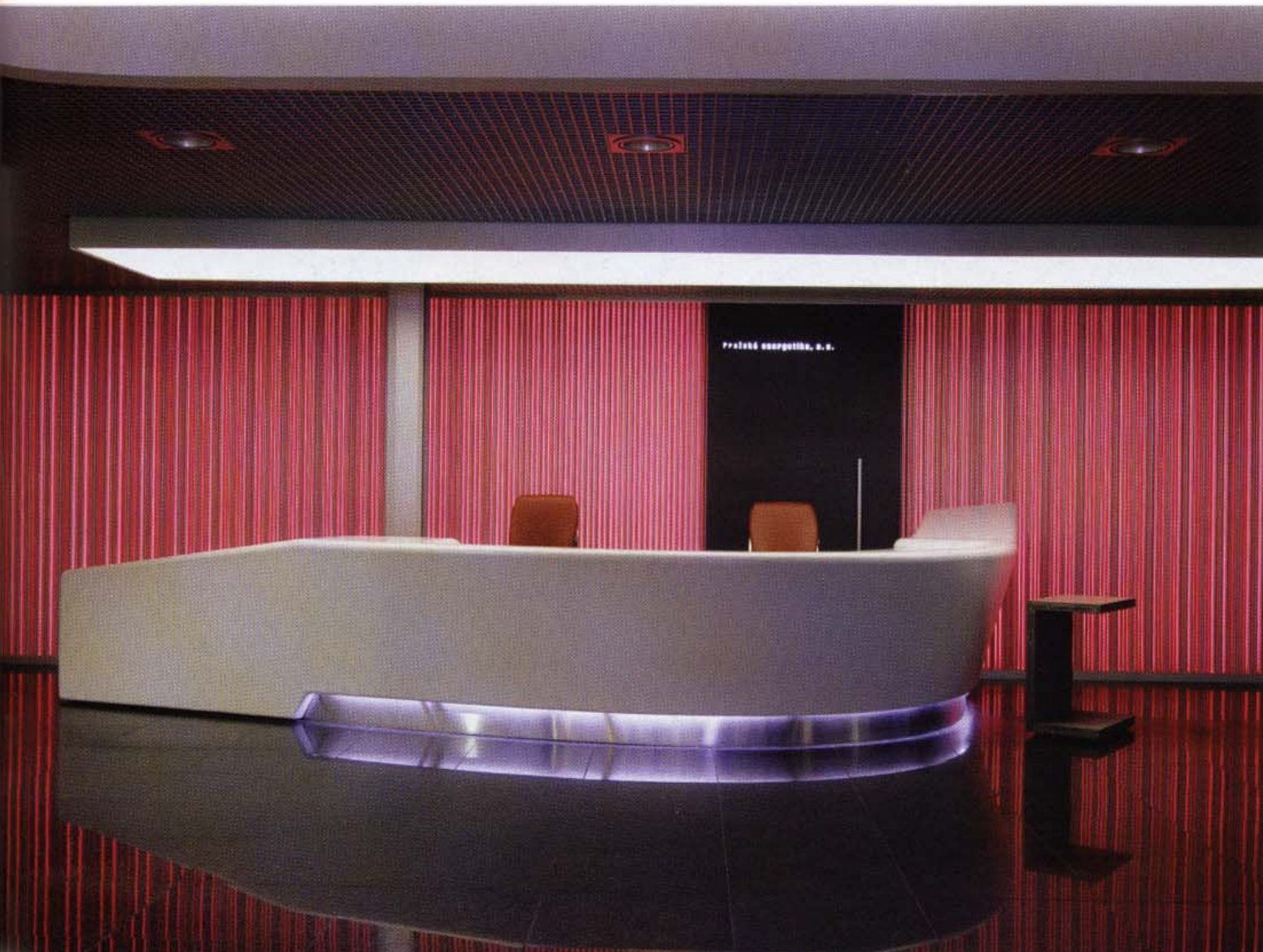
Na protější straně a nahoře: Recepční pult – přes šest metrů dlouhá sklolaminátová skořepina – byl vyroben ručně v jednom kuse obdobným postupem, jako se vyrábí např. trupy letadel nebo lodí. Povrchovou vícevrstvou lakovanou úpravou s proložení lesklých a matných vrstev bylo dosaženo toho, že řádky bílého písma v bílém pultu vytváří jemný vzor, viditelný jen v závislosti na odrazu světla. Dole: Součástí vstupní haly je i jednací salonek.
